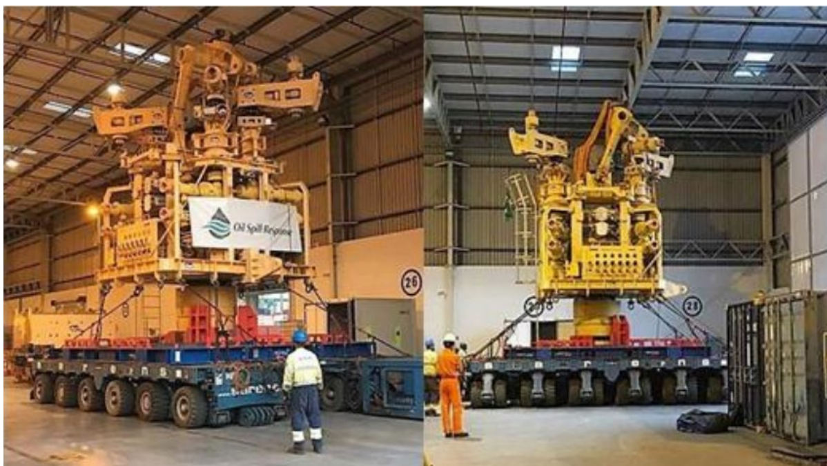
Figura 3-3 Sistema de taponamiento submarino en Río de Janeiro.
